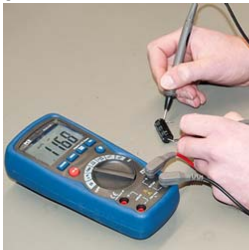
Hier sehen Sie das LCR Multimeter bei der Messung einer Kapazität.
