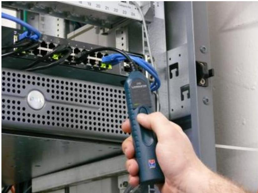
Hier ist der LanMaster bei einem Test zu sehen, bei dem die Art des Signals gesucht wird, welches am RJ45-Port anliegt.
