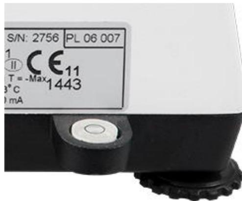
Wasserlibelle zum Ausrichten der PCE-LSM Laborwaage
