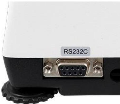
Bidirektionale RS-232 Schnittstelle der Laborwaage PCE-LSM Serie
