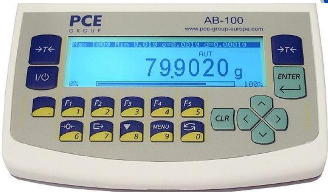
Display der Laborwaage mit ansteigendem Leuchtband,
