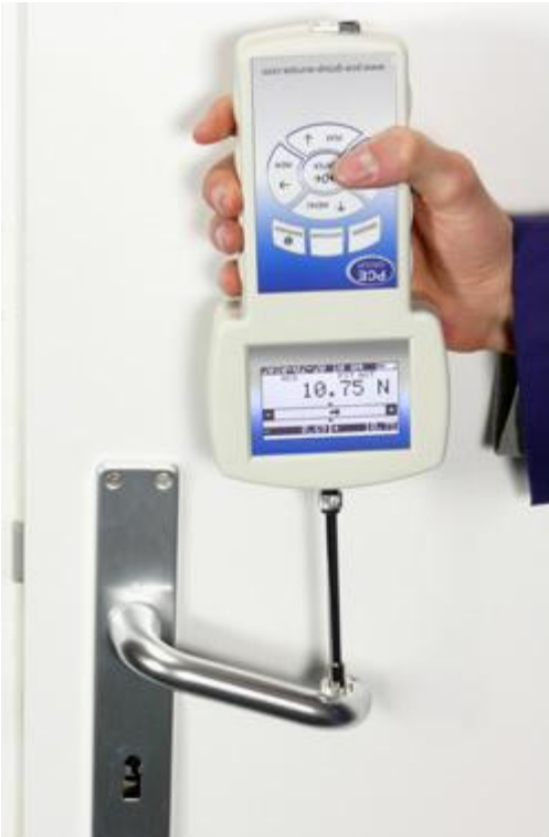
Die Kraftmessdose während einer Druckkraftmessung
