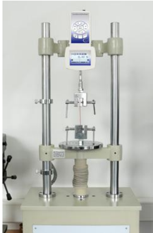
Die Kraftmessdose während einer Zugkraftmessung
