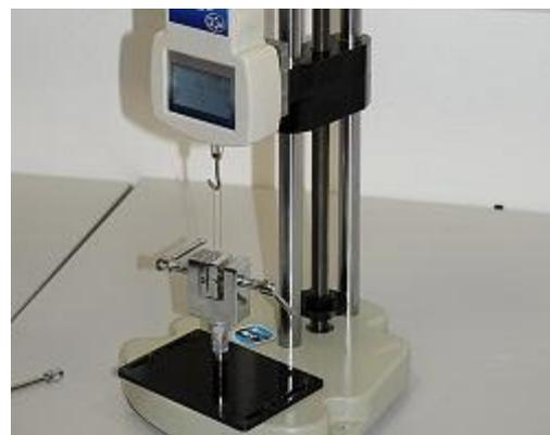
Zugkraftmessung mit dem **Kraft-Prüfstand**
