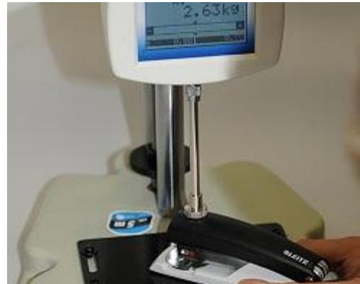
Druckkraftmessung mit dem **Kraft-Prüfstand**
