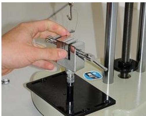
Zugkraftmessung mit dem **Kraft-Prüfstand**
