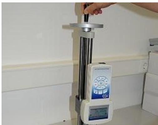
Zugkraftmessung mit dem **Kraft-Prüfstand**
