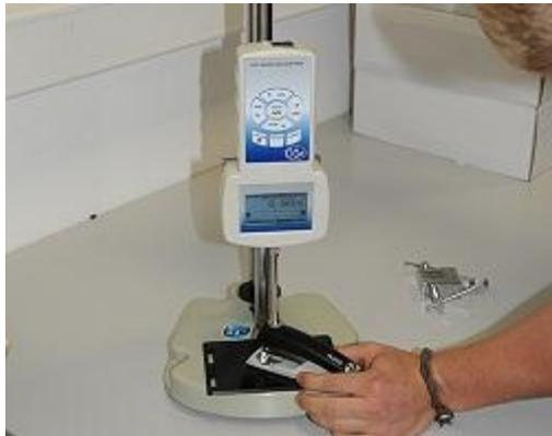
Druckkraftmessung mit dem **Kraft-Prüfstand**
