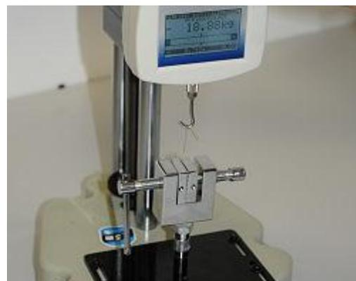
Zugkraftmessung mit dem **Kraft-Prüfstand**
