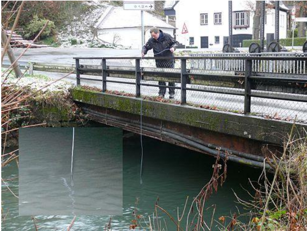
Der wasserdichte Datenlogger PCE-T 200W im Einsatz bei der Temperaturmessung / Aufzeichnung in einem Gewässer
