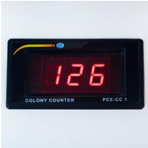
Der Kolonienzähler PCE-CC 1 besitzt ein 3-stelliges LED Display, mit dem Zählungen bis zu einem Wert von 999 möglich sind. Das Display lässt sich gut ablesen und ist somit ideal für den Einsatz im Labor geeignet.
