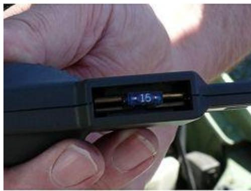
Hier sehen Sie den Flachsicherungsadapter des KFZ Strommessgerät PCE-ACT 8 mit eingesteckter Miniflachsicherung.
