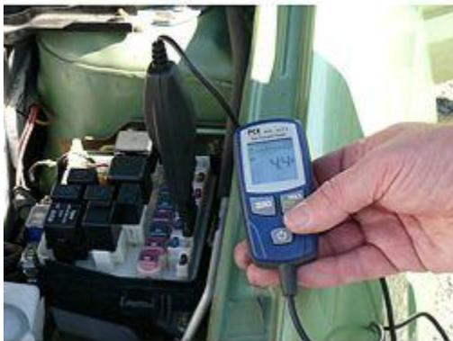
Hier sehen Sie das KFZ Amperemeter PCE-ACT 8 mit angeschlossenem Flachsicherungsmessadapter an einer KFZ Sicherungsbox.
