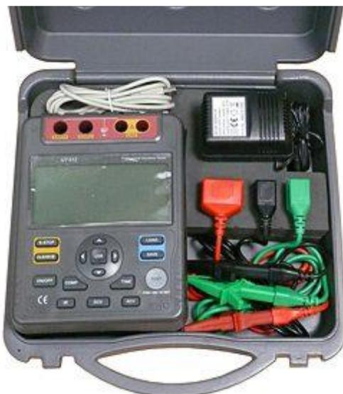
Das Isolationstestgerät PCE-UT 512 ist in einem handlichen Koffer verpackt.
