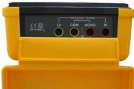
Durch Zurückklappen des gelben Schutzdeckels vom Isolationmessgerät (nach hinten) wird eine Steckleiste für die Anschlusskabel sichtbar. Das Gerät verfügt über eine doppelte Ableitung. Zwei gelbe Eingangsbuchsen, je bezeichnet mit Lo und COM, sowie zwei rote Eingangsbuchsen, jeweils bezeichnet mit ACV /  $\Omega$  und Hi ermöglichen eine sichere Adaption der Prüfleitungen. Die Anschlussbelegung (je nach Art der Messfunktion) entnehmen Sie bitte der Bedienungsanleitung (siehe oben).
