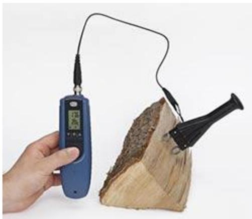
Holzfeuchtemessgerät Hydromette BL H40 mit Einschlagelektrode.
