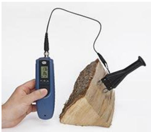
Holzfeuchtemessgerät Hydromette BL H40 mit Einschlagelektrode.
