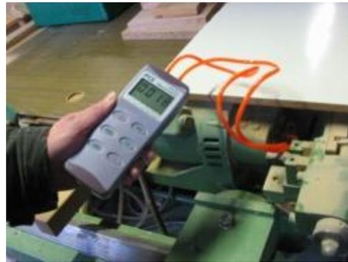
Hier sehen Sie das Profimessgerät bei einer Messung des Luftdrucks in einer Maschine. Bedenken Sie bitte die maximal zu messenden Drücke bevor Sie ein Druckmessgerät bestellen oder einsetzen, da eine Überlastung zur Zerstörung des Druckmessgerätes führt. Die Messgerät-Typen und ihre Spezifikationen sehen Sie unten in der Tabelle.
