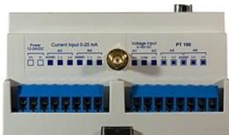
Hier sehen Sie die analogen Eingänge der Anschlussleiste des GSM-Datenlogger R-Log
