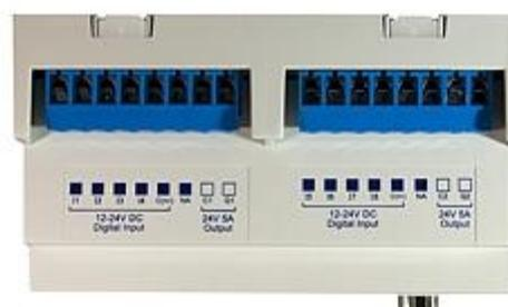
Hier sehen Sie die digitalen Eingänge der Anschlussleiste des GSM-Datenlogger R-Log
