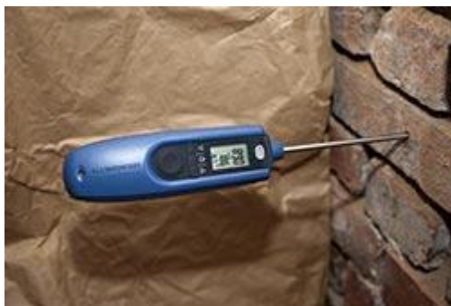
Gleichgewichtsfeuchte Messer Hydromette BL Compact RH-T bei der Messung in einem Bohrloch
