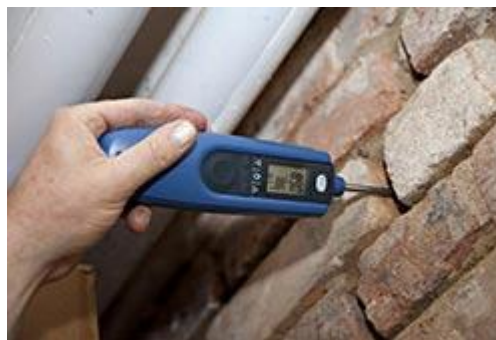
Gleichgewichtsfeuchte Messer Hydromette BL Compact RH-T bei der Messung in einer Mauerfuge
