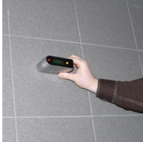
Hier sehen Sie das Glanzmessgerät PCE-GM 50 bei der Glanzmessung einer Fliesenoberfläche.
