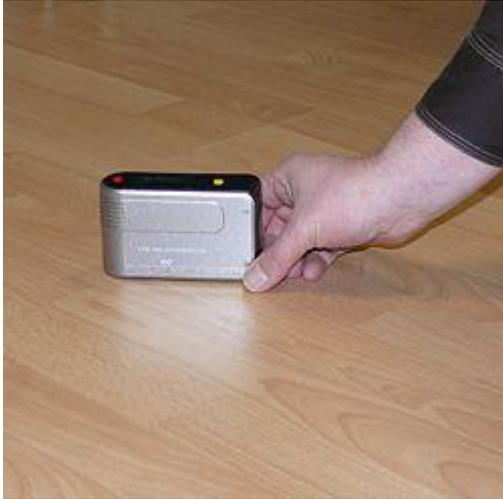
Hier sehen Sie das Glanzmessgerät PCE-GM 50 bei einer Messung auf einer versiegelten Fläche.
