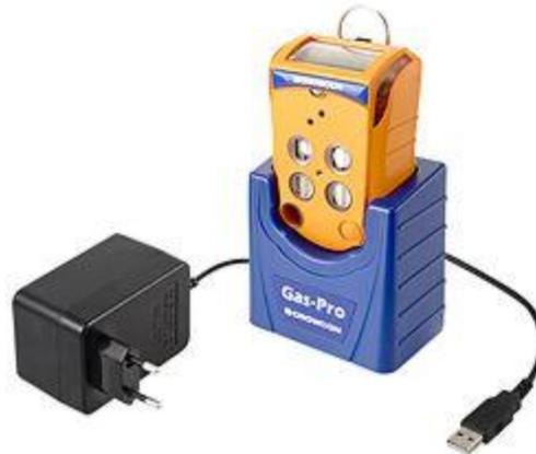
Gasmelder Gas-Pro im Ladegerät mit Interface
