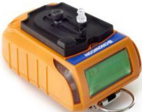
Gasmelder Gas-Pro mit Ansaugkappe bei Pumpenbetrieb
