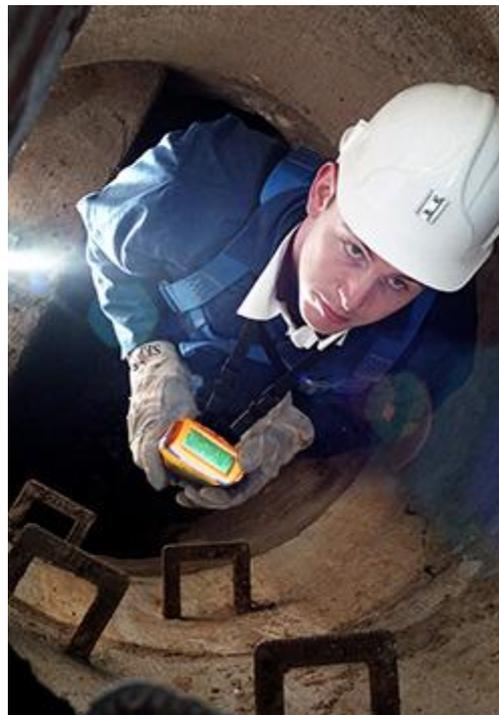
Gasmelder Gas-Pro zum Personenschutz bei Wartungsarbeiten im Kanalnetz
