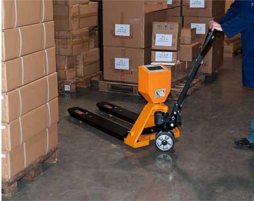
Gabelhubwagen mit Waage und Drucker PCE-PTS 2M im Einsatz
