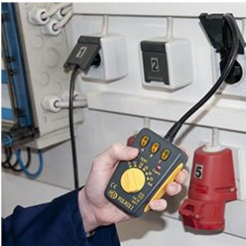
Das FI-Prüfgerät PCE-RCD 2 bei der Prüfung von Schuko-Steckdosen. Die Bedienung ist schnell und unkompliziert.
