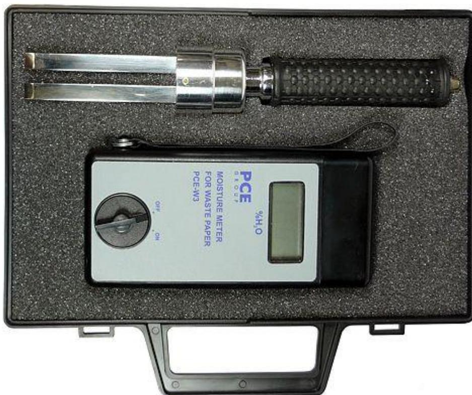
Die Abbildung zeigt das Altpapier-Feuchtemessgerät im Tragekoffer
