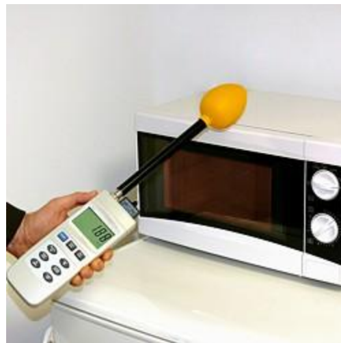
Das Feldstärkenmessgerät kann auch bei Mikrowellen benutzt werden
