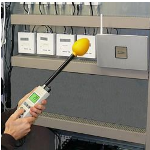
Das Feldstärkenmessgerät wird z.B. zur Erfassung von Wireless LAN eingesetzt
