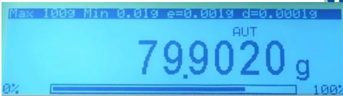
Grafik-Display mit Stabilitätsanzeige und ansteigendem Leuchtband (zeigt den noch zur Verfügung stehenden Wägebereich der Feinwaage an)
