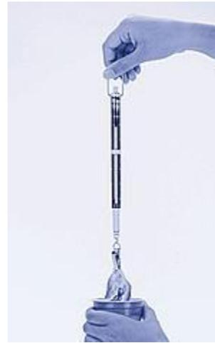
Federwaage als Zugkraftmesser
