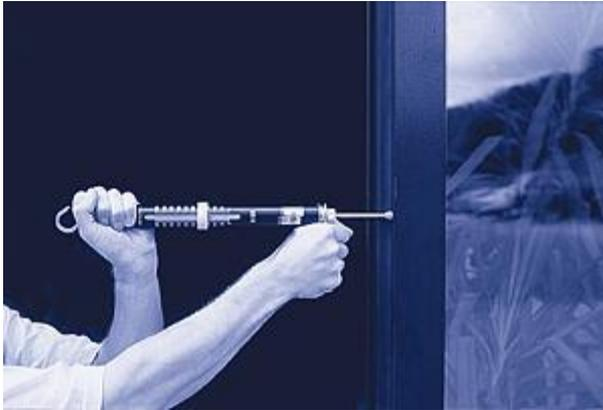
Federwaage als Druckkraftmesser
