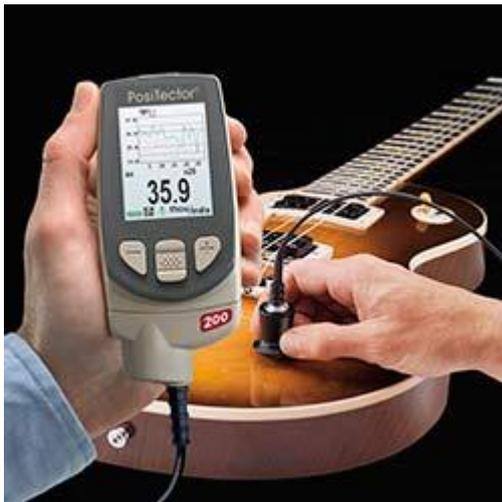
Hier sehen Sie den Farbschichtdickenmesser PT-200 bei einer Messung an einer Gitarre.
