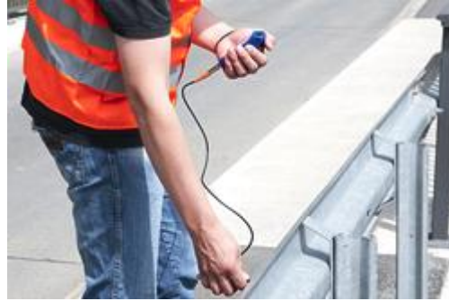
Das Farbschichtdicke-Messgerät bei einer Überprüfung an einer Leitplanke.
