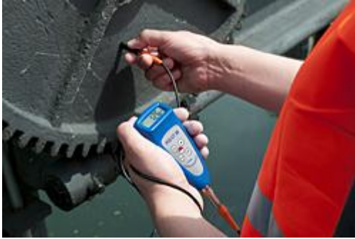
Das Farbschichtdicke-Messgerät bei einer Farbschichtmessung an einem Zahnrad.
