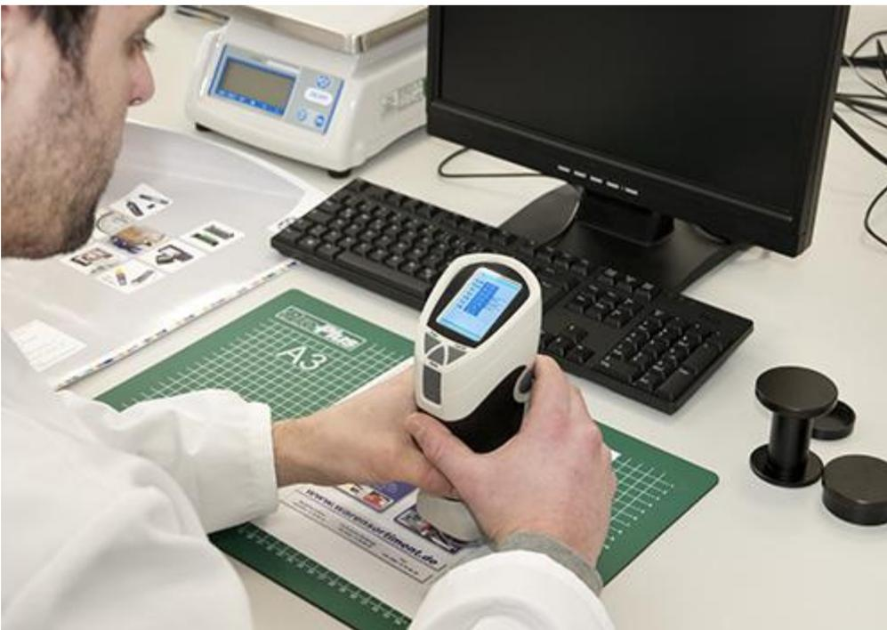
Mit dem Farbmessgerät PCE-TCR 200 ist es möglich den  $\Delta E$  von Druckproben zu messen.
