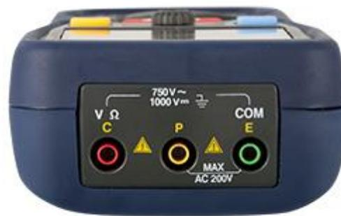
Die Messleitungen vom Erdungstestgerät sind zur leichteren Orientierung farblich gekennzeichnet
