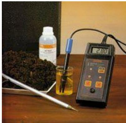
Wenn Sie mit der direkten Verwendung der Elektrode keine gute Messung erzielen, weil z.B. der Boden zu trocken ist, müssen Sie eine Bodenlösung ansetzen und diese dann mit dem Leitfähigkeitsmessgerät prüfen. Aus den folgend gemachten Angaben können keine Gewährleistungs- und Haftungsansprüche geltend gemacht werden.
