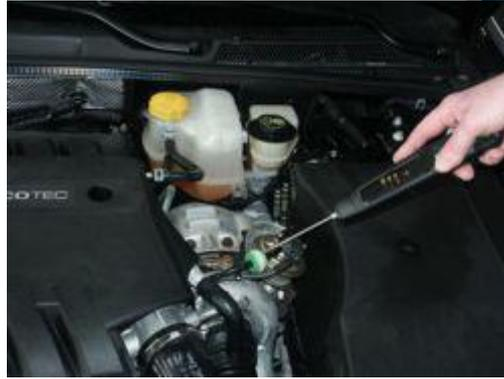
Das elektronische Stethoskop PCE-S 41 im Einsatz bei der Überprüfung eines Turboladers.
