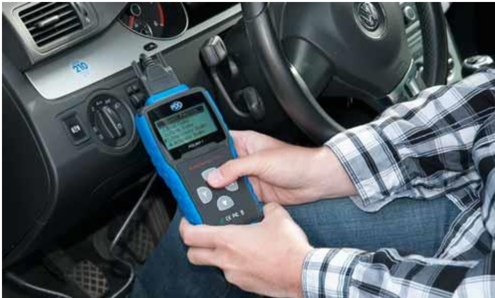
Der elektronische Bremskolbenrücksteller PCE-BST 1 beim deaktivieren einer Parkbremse
