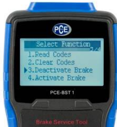
Der Bremskolbenrücksteller mit gut ablesbarem LC-Display
