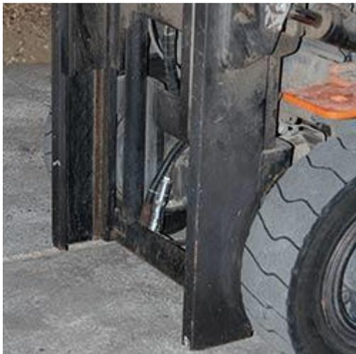
Hier sehen Sie die Einsteiger-Hydraulikwaage PCE-FLW 1 an einem Gabelstapler angebracht. Mit Hilfe der Einsteiger-Hydraulikwaage ist es möglich, einfach und bequem, das Gewicht der Ladung festzustellen. Gerade für industrielle Betriebe ist dies unverzichtbar.
