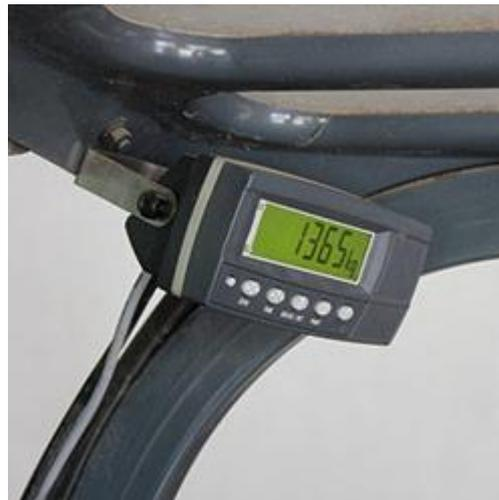
Hier sehen Sie die das Display einer Einsteiger-Hydraulikwaage PCE-FLW 1 in der Fahrerkabine eines Gabelstaplers montiert. Mit der Halterungsvorrichtung ist es somit möglich das Gewicht der Ladung zu jeder Zeit abzulesen und zu kontrollieren.
