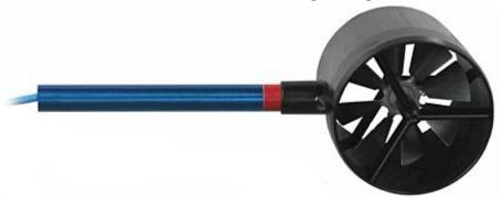
Luft-Fühler MiniAirJunior Macro 95.2014 Macro 95.2009 Strömungs-Messbereich 0,3 ... 20 m/s 0,4 ... 40 m/s ±1,0 % v.E. Messgenauigkeit der Strömung ±3,0 % v..E -30 ... 140 °C Einsatztemperatur Kopfgröße Ø 85 x 80 mm 235 mm Fühlerlänge 1,5 m Kabellänge -65 ... 150 °C Lagertemperatur
