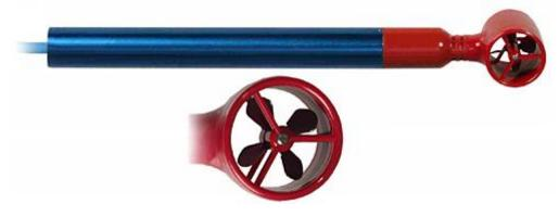
Luft-Fühler für MiniAirJuniorMini 95.2004Mini 95.2005Strömungs-Messbereich0,4 ... 20 m/s0,5 ... 40 m/s
