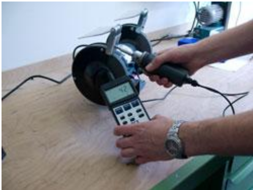
Der Drehmomentprüfer bei der Messung des Lösemoments an einem Schleifgerät.
