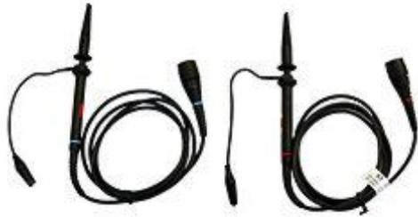
Hier sehen Sie die universellen Tastköpfe welche im Lieferumfang des enthalten sind. Da man das Spannungsteiler Verhältnis auch auf 10:1 umstellen kann, können Signale bis zu 50V angezeigt werden. Über einen Drehkondensator können Verfälschungen des Signals kompensiert werden.
