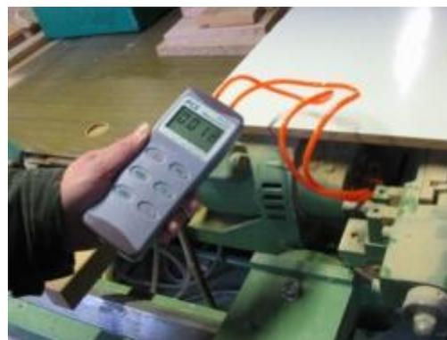
Hier sehen Sie das Profimessgerät bei einer Messung des Luftdrucks in einer Maschine. Bedenken Sie bitte die maximal zu messenden Drücke bevor Sie ein Druckmessgerät bestellen oder einsetzen, da eine Überlastung zur Zerstörung des Druckmessgerätes führt. Die Messgerät-Typen und ihre Spezifikationen sehen Sie unten in der Tabelle.
