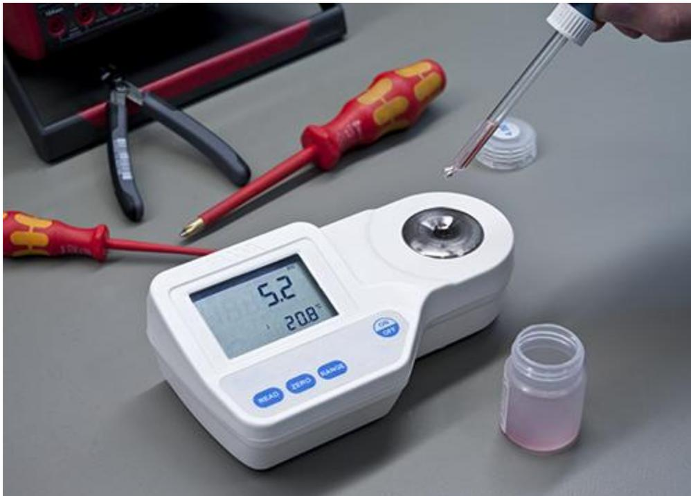
Digitalrefraktometer bei der Messung
