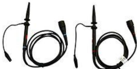
Hier sehen Sie die universellen Tastköpfe welche im Lieferumfang des enthalten sind. Da man das Spannungsteiler Verhältnis auch auf 10:1 umstellen kann, können Signale bis zu 50V angezeigt werden. Über einen Drehkondensator können Verfälschungen des Signals kompensiert werden.
