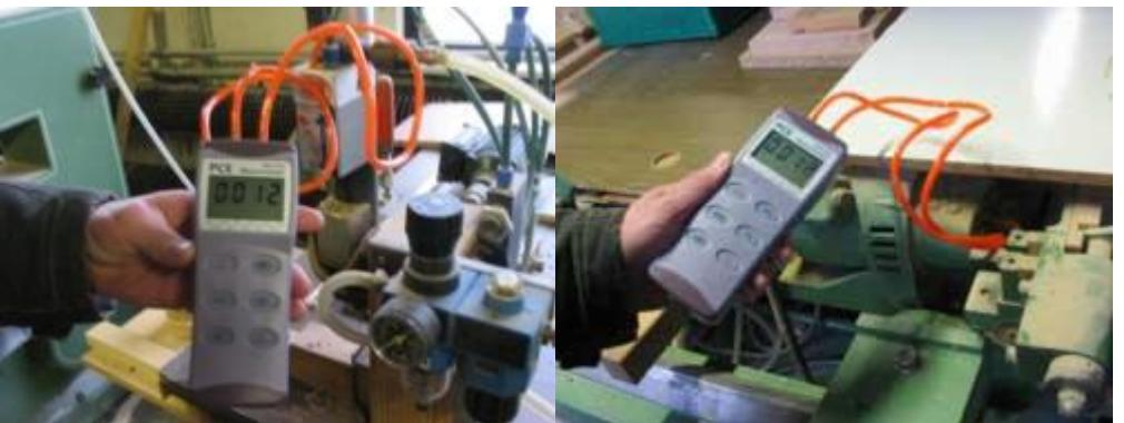
Hier sehen Sie das Profimessgerät bei einer Messung des Luftdrucks in Maschinen. Bedenken Sie bitte die maximal zu messenden Drücke bevor Sie ein Druckmessgerät bestellen oder einsetzen, da eine Überlastung zur Zerstörung des Druckmessgerätes führt. Die Messgerät-Typen und ihre Spezifikationen sehen Sie unten in der Tabelle.
