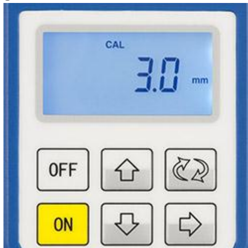
Hier sehen Sie das Dickenmessgerät im Kalibriermodus
