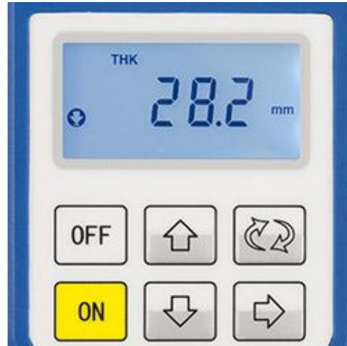
So zeigt das Dickenmessgerät den Messwert an, wenn Sie messen
