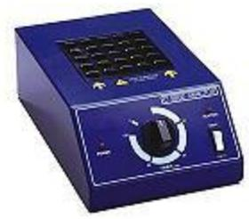
Wahlweise lassen sich zwei Reaktionstemperaturen benutzer- definiert auswählen: Eine Reaktionstemperatur von 150 °C und eine Temperatur von 105 °C für die Bestimmung von Gesamtphosphat und Gesamtstickstoff.
