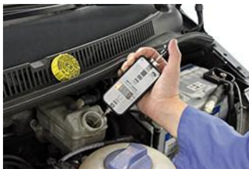
Hier der Bremsflüssigkeits-Prüfer beim ablesen
