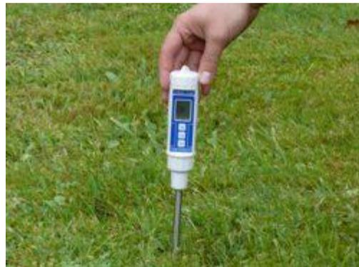
Hier sehen Sie das Bodenfeuchte-Messgerät im Einsatz bei der Ermittlung der Feuchtigkeit im Erdboden.
