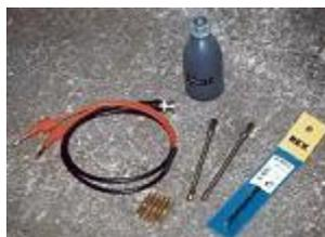
Zur genauen Messung der Feuchte in verschiedenen Beton-Tiefen
