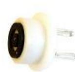
Wird mit den beiden Steckern an den Universalfühlerhalter gekoppelt/ die Feuchtemessung geschieht an der schwarzen Messfläche/ dieser Fühler / arbeitet kontaktierend und völlig zerstörungsfrei/ besonders geeignet für Messung auf Tapeten, Kunststoffen, besonders wertvollen Holz- und Baustoffoberflächen, wo eine zerstörungsfreie Messung wichtig ist.
