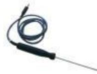
Das Baufeuchte - Messgerät verfügt über eine automatische Temperaturkompensation. Dazu muss der Temperaturfühler an das Gerät angeschlossen werden.
