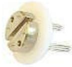
Wird mit den beiden Steckern an den Universalfühlerhalter gekoppelt/ die Feuchtemessung geschieht auf der zweigeteilten runden Metallfläche über 4 Mininadeln (1,5mm lang)/ besonders geeignet zur Messung z.B. der Korkfeuchte, Gummifeuchte und für weiche und nachgebende Baustoffe und auch Dachpappe.
