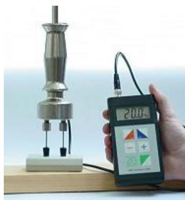
Weiterhin zu beachten ist die Temperatur. Da die Materialtemperatur die elektrische Leitfähigkeit beeinflusst (und somit die Feuchte), muss eine Temperaturkompensation vorgenommen werden. Dies kann mittels des additional erhältlichen Temperaturfühlers automatisch erfolgen.
