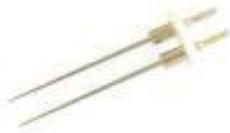
Wird mit den beiden Steckern an den Universalfühlerhalter gekoppelt/ die Feuchtemessung geschieht über die beiden Nadelspitzen/ besonders geeignet für Holz mit größeren Durchmesser, Sparren, Planken, aber auch für Dämmmaterialien mit großer Materialstärke, wie Dämmwolle oder für Leichtbaumaterialien poröser Art, wie Yton-Steine, PU-Schäume.
