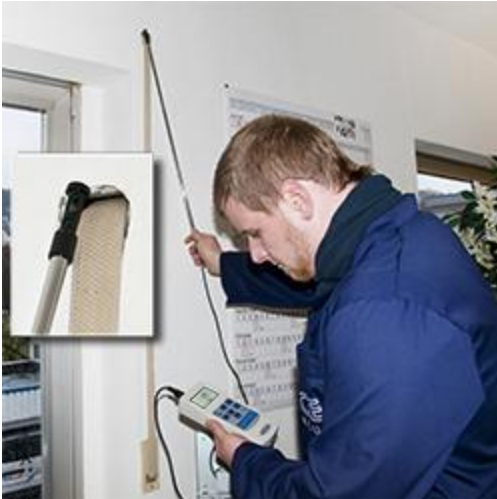
Das Anemometer PCE-424 bei einer Zugluftmessung an einem Fenster
