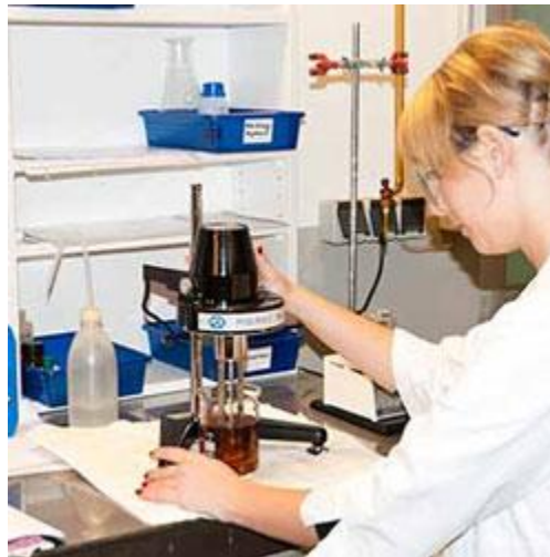
Hier sehen Sie das analoge Viskositätsmessgerät im Laboreinsatz..
