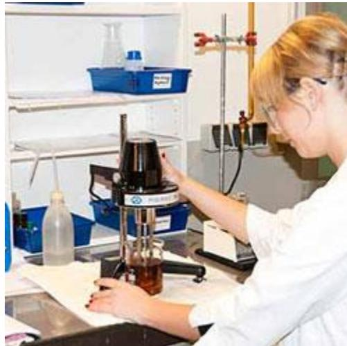
Hier sehen Sie das analoge Viskositätmessgerät im Laboreinsatz..
