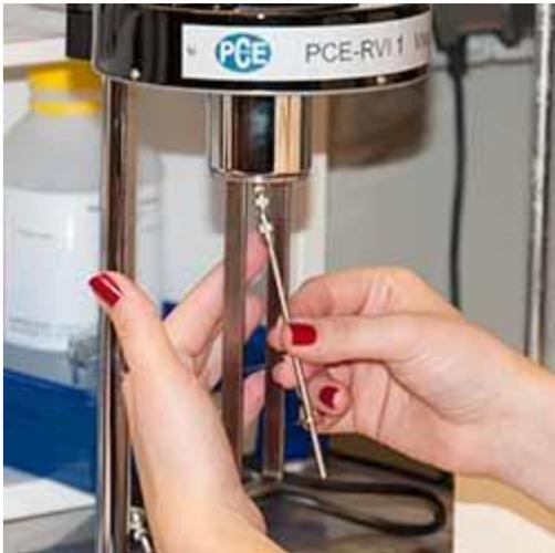
Hier sehen Sie unser Viskositätmessgerät bei einem Wechsel der Spindel.
