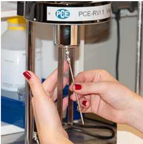
Hier sehen Sie unser Viskositätsmessgerät bei einem Wechsel der Spindel.
