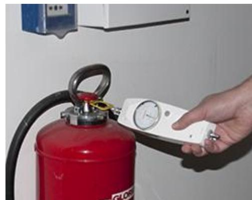
Hier sehen Sie das analog Kraftmessgerät bei einer Feuerlöscherüberprüfung.
