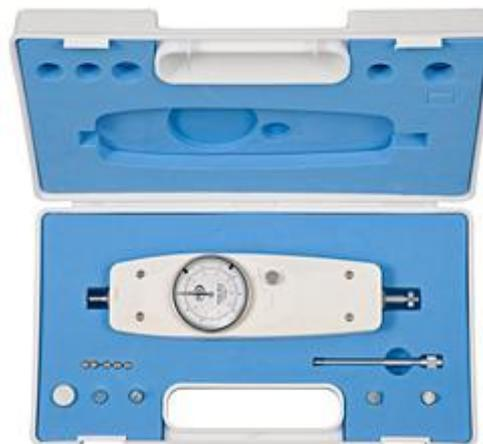
Hier sehen Sie den Lieferumfang für das analog Kraftmessgerät PCE-SN Serie.
