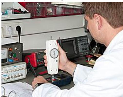
Hier sehen Sie das analog Kraftmessgerät bei einer Tastenüberprüfung.
