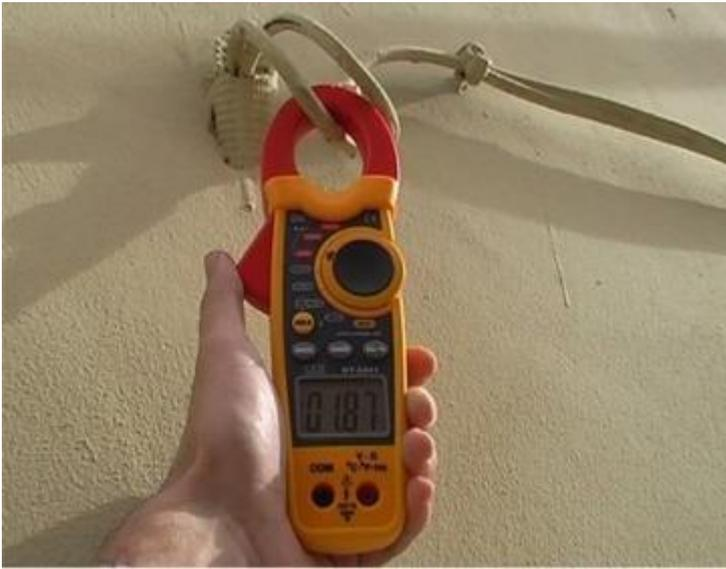
Amperemeter DT- 3341 bei der Messung des Stromes in einem Gebäude.
