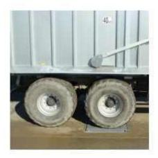
Durch die in der Plattform verbauten Sensoren in kann die Achslastwaage die Anzahl der Achsen selbst ermitteln um das Gesamtgewicht zu errechnen.
