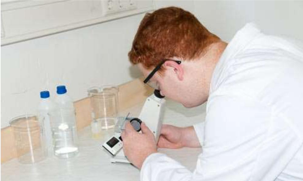
Laborant bei der Arbeit mit dem Abbe-Refraktometer
