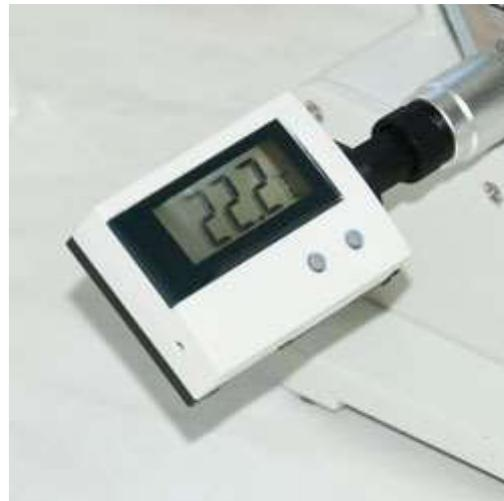
Abbe-Refraktometer mit Thermometer zur Berechnung des korrekten Refraktionsindex
