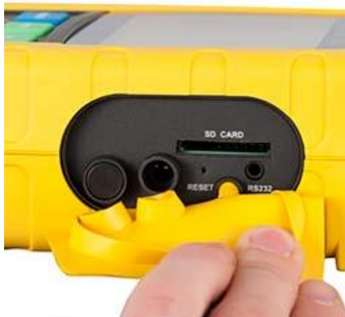
Die Anschlüsse vom 4-Kanal-Vibrationsdatenlogger PCE-VM 5000.
